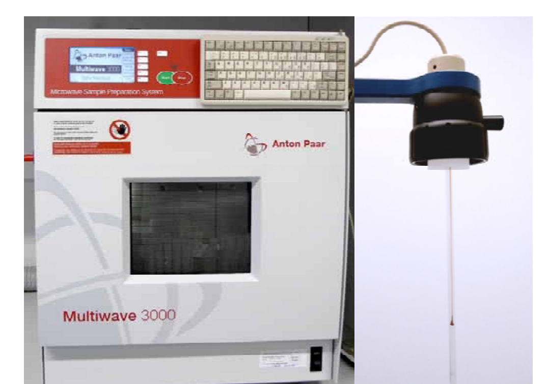
Paar Multiwave 3000, TFM-Gefäße, Rotor 16, kalibrierter pT-Innensensor zur Temperaturmessung
