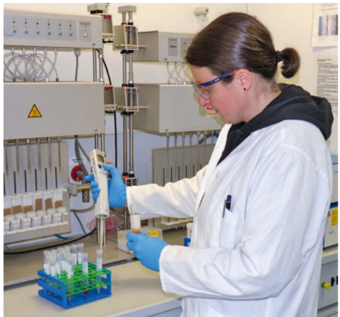
Probenaufarbeitung von Gemüse zur PFAS-Bestimmung
