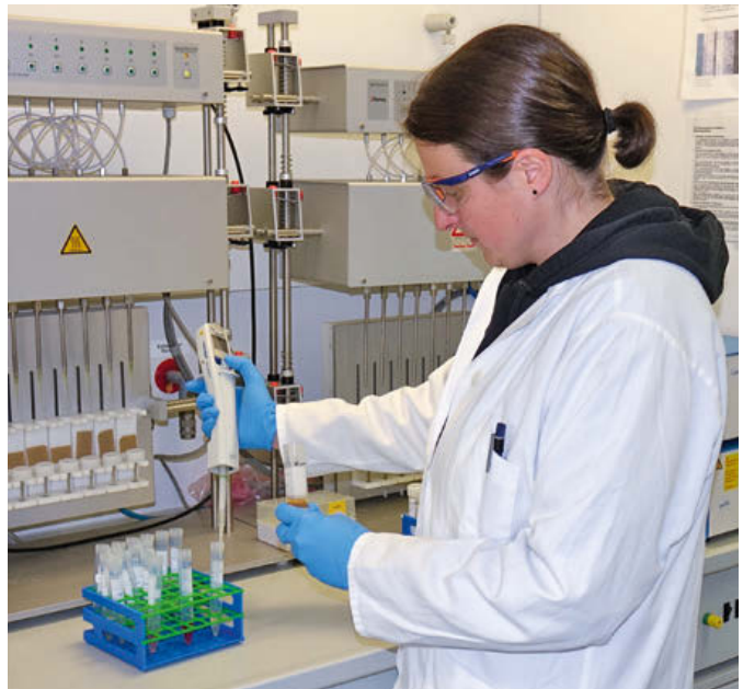
Probenaufarbeitung von Gemüse zur PFAS-Bestimmung
