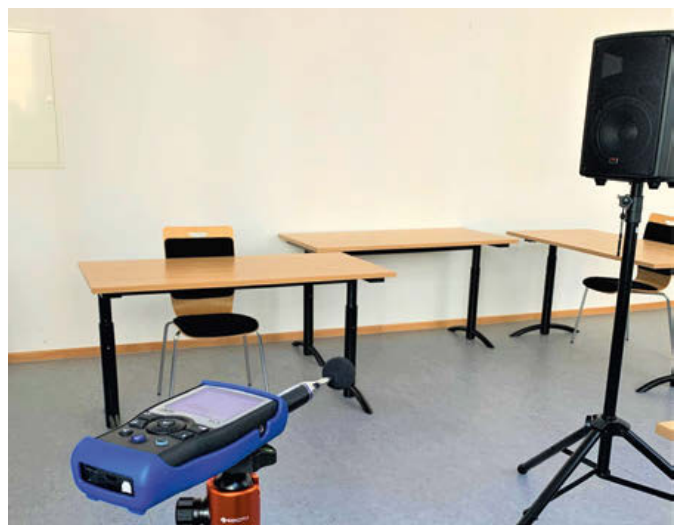
Messung der Nachhallzeit mittels Schallpegelmesser und Lautsprecher
